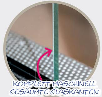
KOMPLETT MASCHINELL GESÄUMTE GLASKANTEN
